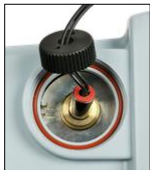
Install the new tungsten filament lamp module.
