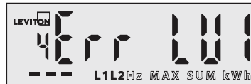
Pantalla de error que muestra un error de instalación de voltaje bajo en las Líneas 1 y 2
