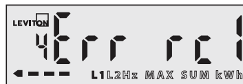
Pantalla de error que muestra un error de instalación de corriente inversa en la Línea 1
