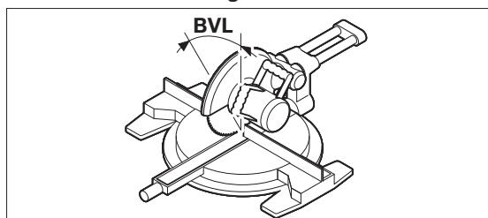
Appuyez à nouveau sur le bouton **15. « BVL »** et l'angle d'onglet calculé pour la scie à déchiqueter/scie à onglet sont indiqués sur l'écran d'affichage.
