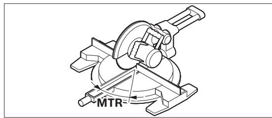
Appuyez sur le bouton **14**. L'angle d'onglet horizontal calculé « **MTR** », qui doit être paramétré sur la scie à déchiqueter/scie à onglet, et l'indicateur « **MTR** » seront affichés sur l'écran.
