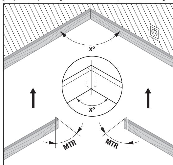
L'angle d'onglet « **MTR** », par lequel les deux ouvrages doivent être raccourcis, est calculé. Pour ces coupes d'onglets, la lame de la scie est verticale par rapport à l'ouvrage (l'angle de biseau est de 0°).
