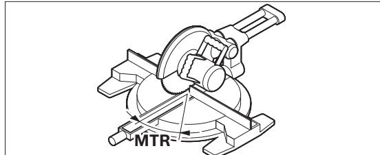
Appuyez à nouveau sur le bouton **15. « MTR »** et l'angle d'onglet calculé pour la scie à déchiqueter/scie à onglet sont indiqués sur l'écran d'affichage.
