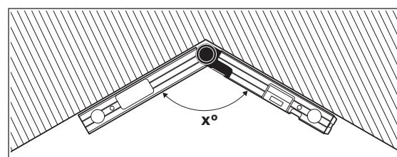
Lorsque des ouvrages doivent être placés dans un coin (p. ex., dans le cas de l'éboutage pour un plancher), mesurez l'angle de coin **x°** en appliquant le pied pliant et le pied de la base. Pour des angles donnés (p. ex., des cadres pour tableaux), ouvrez le pied pliant et le pied de la base jusqu'à ce que l'angle désiré soit indiqué sur l'affichage.
