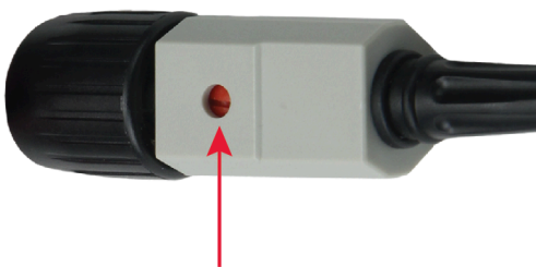
Figure 2: Réglages de la compensation en fréquence
