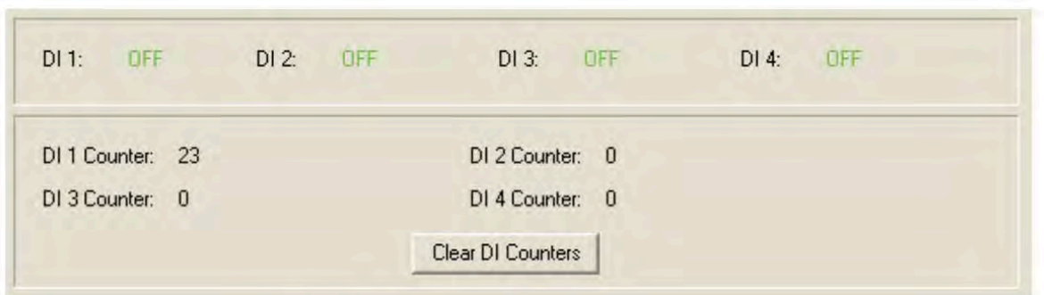
Fig.3-98 DI counter and status display
