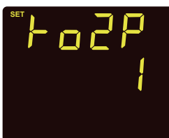
Fig 3-33 RO2 Alarm Parameter Setting
