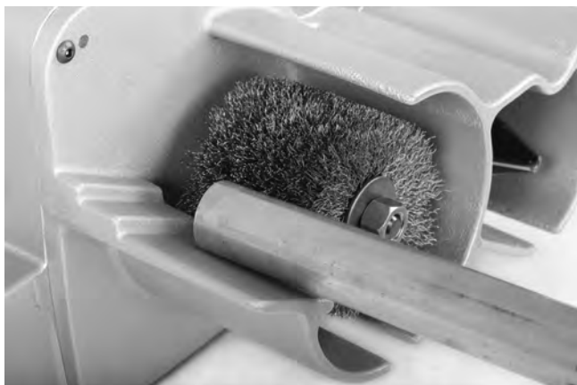
Figure 11 – Nettoyage externe du tube
