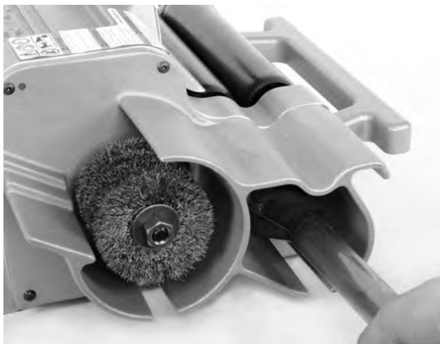
Figura 13 – Escariado del interior del tubo
