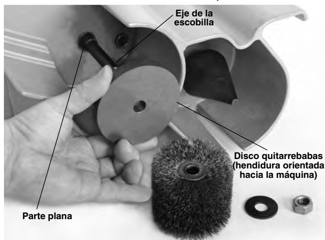
Figura 5 – Montaje del disco quitarrebabas
