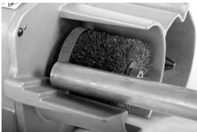
Figura 12 – Eliminación de rebabas del exterior del tubo
