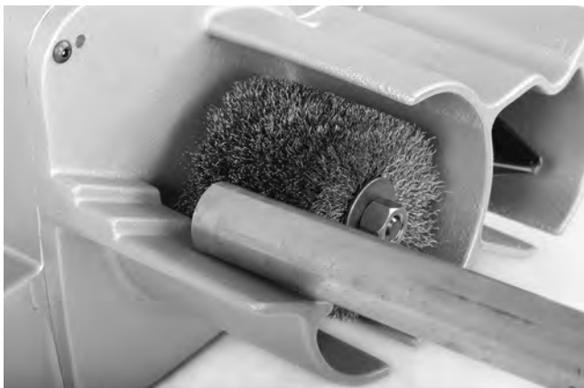
Figura 11 – Limpieza del exterior del tubo
