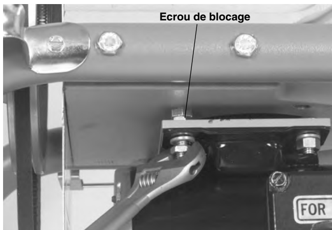
Figure 15 – Réglage de la courroie d'entraînement
