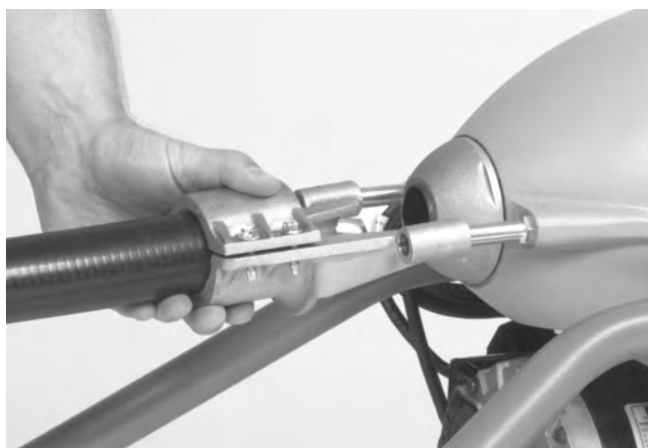
Figura 3 – Conexión de la manguera guía trasera
