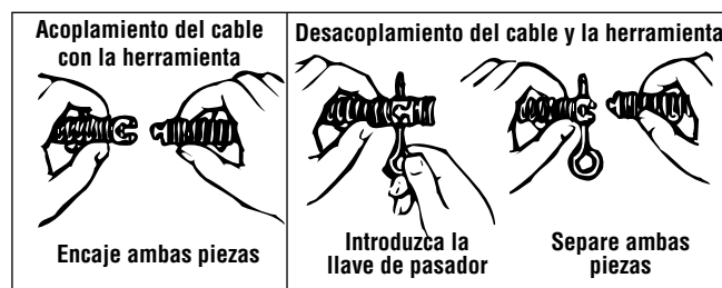
Figura 5 – Acoplamiento y desacoplamiento de herramientas
