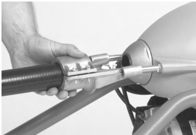
Figure 3 – Montage du guide-câble arrière
