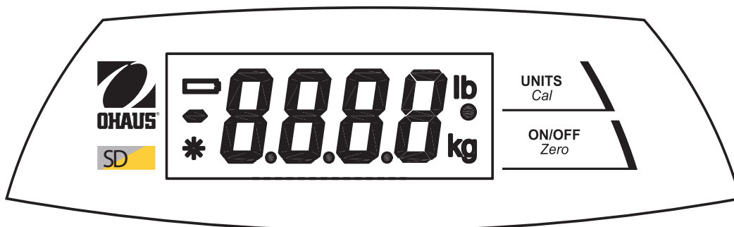
Figura 5. Controlli del pannello dell'indicatore.
