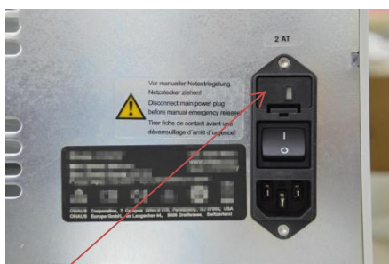
Sicherungsschublade mit Sicherung 4 AT
