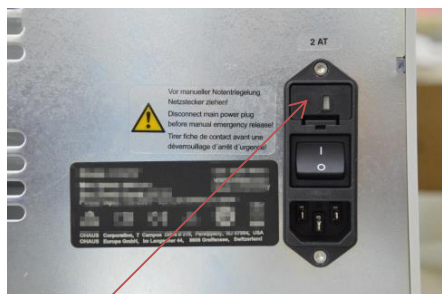
Cassetto portafusibili con fusibile 4 AT
