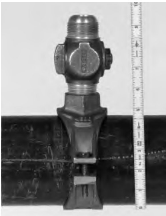
Figura 10 – Medición del recorrido máximo
