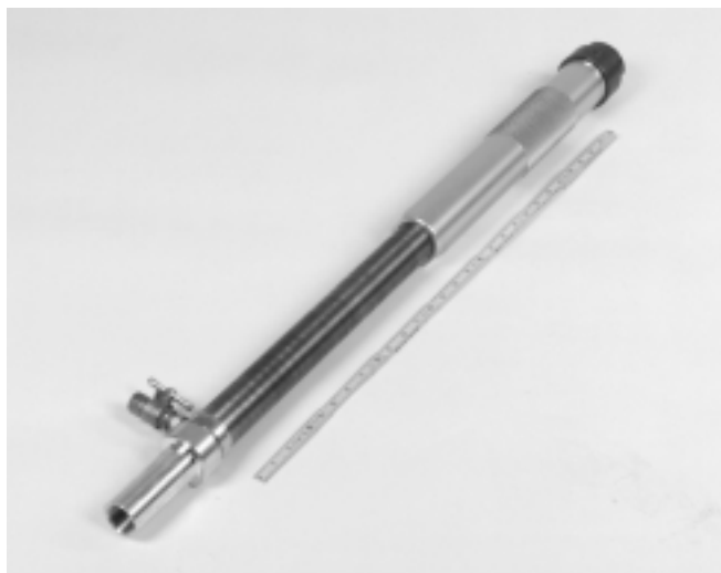
Figura 7 – Medición del total de la carrera
