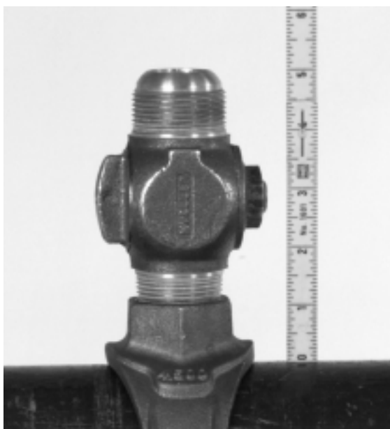
Figure 8 – Relevé du décalage de la vanne.
