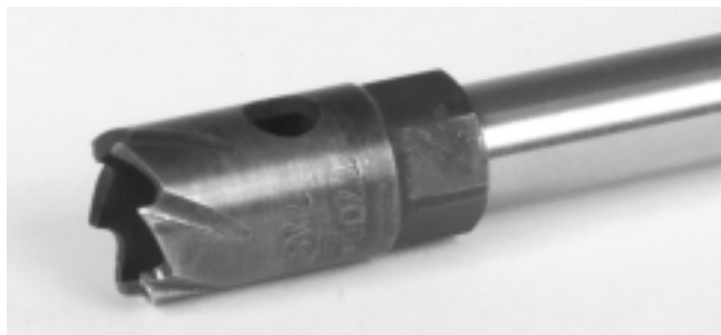
Figura 4 – Montaje de la cortadora en el árbol para sierra de orificio pequeño
