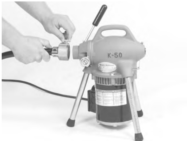
Figure 2 – Montage du guide-câble arrière
