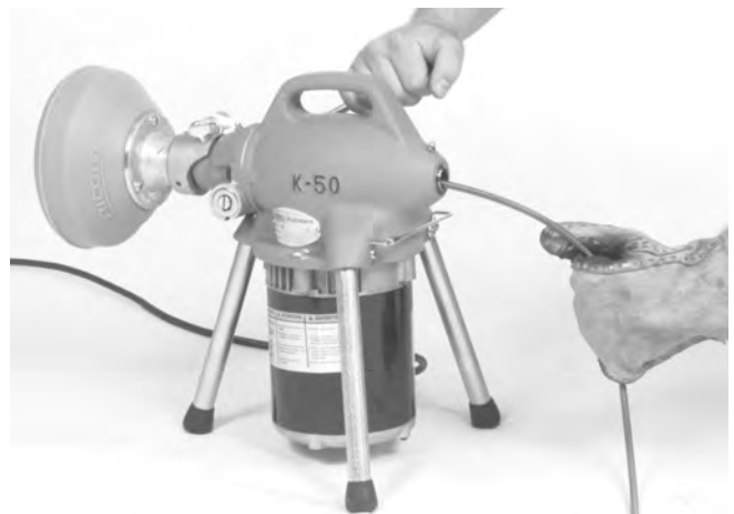
Figura 5 – Acoplamiento del adaptador para el cable
