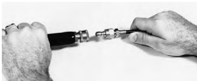
Figura 3 – Acoplamiento de la manguera a la Limpiadora
