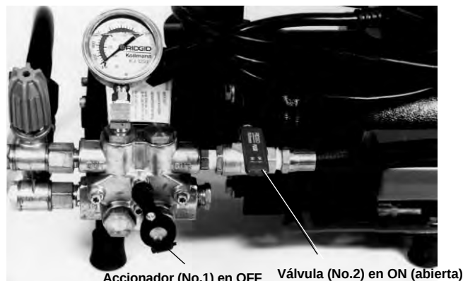
Figura 7 – Para franquear codos y sifones
