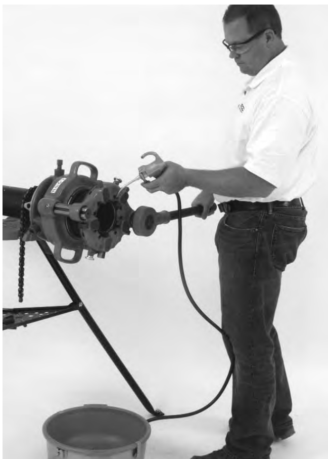
Figure 7 – Utilisation de la clé à cliquet D-1440
