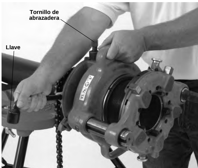
Figura 6 – Cómo apretar el portaherramientas
