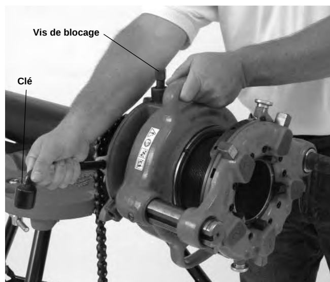
Figure 6 – Serrage de la bride de maintien
