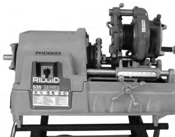
Figure 17 – Fileteuse démultipliée en montage direct avec 535
