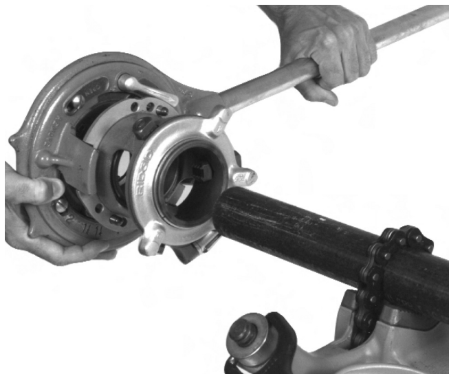
Figure 5 – Montaje de la Roscadora en el tubo
