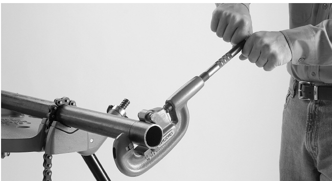
Figure 3 – Corte del extremo de un tubo
