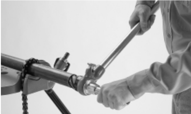
Figura 2 – Escariado del extremo del tubo
