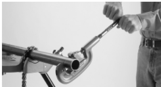
Figura 1 – Corte del extremo del tubo
