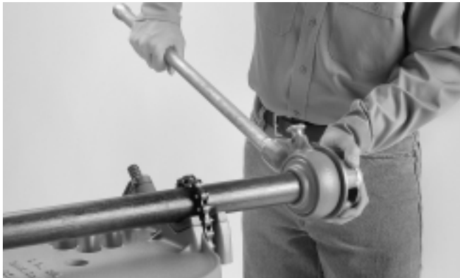
Figura 3 – Montaje de la Roscadora en el tubo
