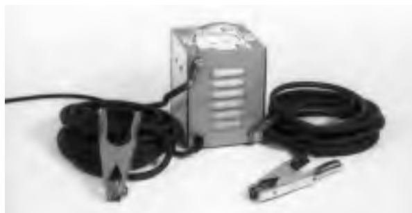
Figura 3 – Descongeladora con los cables acoplados
