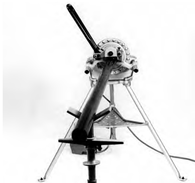
Figure 8A – Desvío del tubo cuando la fuente de accionamiento marcha en REVERSA (REV)
