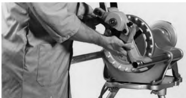
Figure 2 – Montage sur système d'entraînement n° 300
