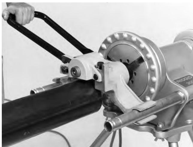
Figura 12 – Formación de una ranura a rodillo
