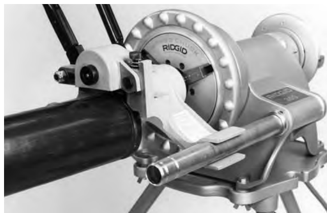
Figure 9 – Levier d'avancement en position relevée
