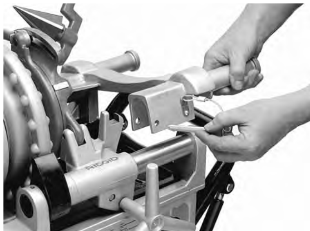
Figure 5 – Montage de l'adaptateur sur la machine à fileter 300 Compact
