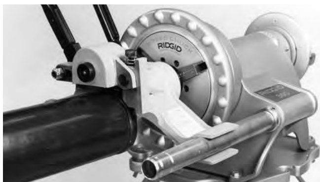
Figura 9 – Mango de alimentación en posición UP (arriba).
