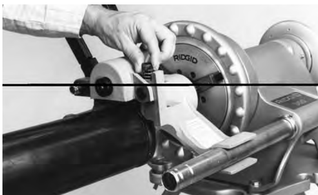
Figura 11 – Apriete el tornillo de regulación de la profundidad
