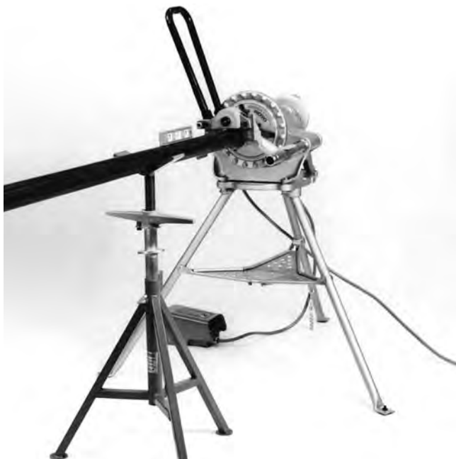
Figure 7 – Nivellement du tuyau.
