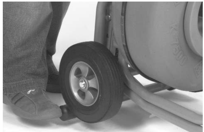
Figura 9 – Inclíne la máquina hacia adelante para desenganchar la barra apoyapiés
