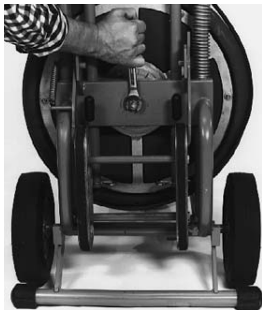
Figura 19 – Extracción del perno en el soporte trasero
