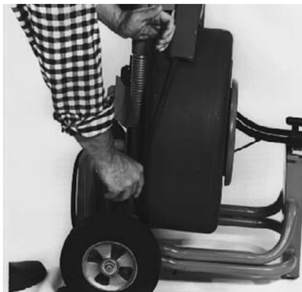
Figura 18 – Afloje la tensión de la correa
