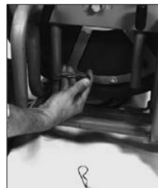
Figure 5 – Verrouillage des poignées à l'aide des goupilles. Serrage des deux (2) manettes en forme de T.
