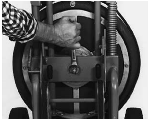
Figura 7 – Revise el perno para asegurar que se encuentra apretado
