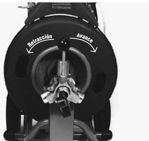
Figura 11 – Funcionamiento de la palanca del AUTOFEED
