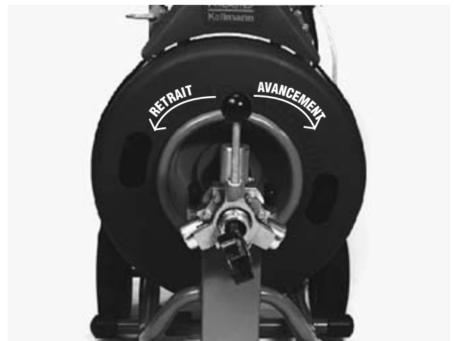
Figure 11 – Utilisation du levier d'entraînement
