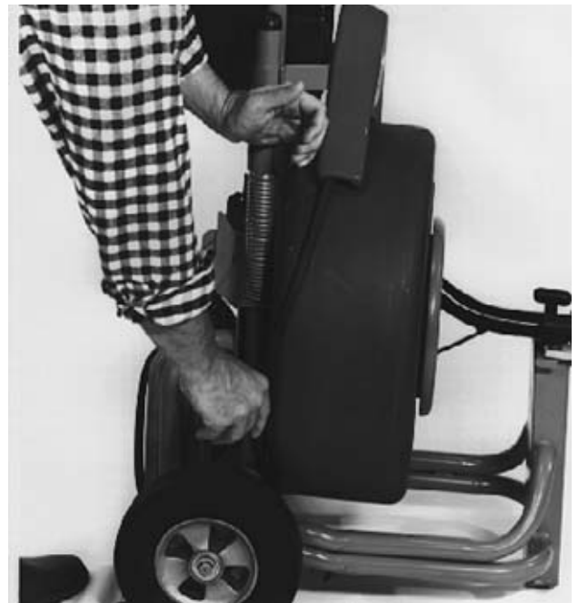
Figure 18 – Soulagement de la courroie
