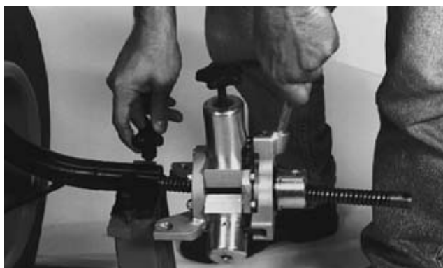
Figure 14 – Retrait du système d'entraînement AUTOFEED
