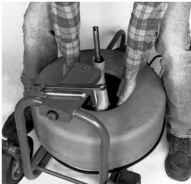
Figure 19 – Dépose du tambour
