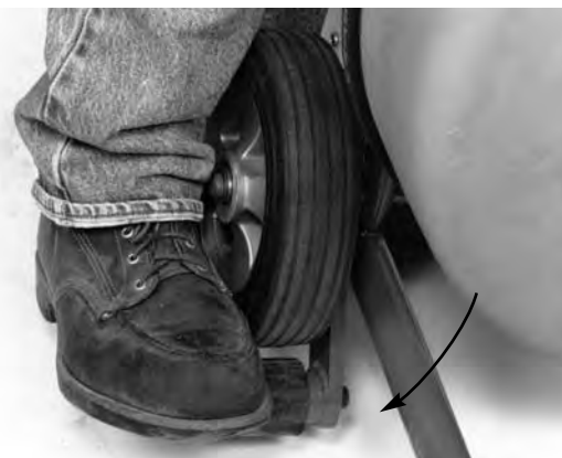
Figure 11 – Déploiement des béquilles
