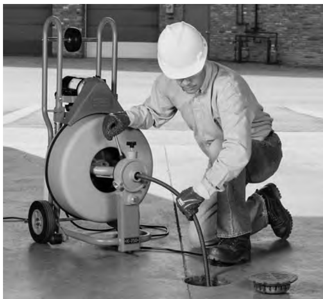
Figure 14 – Utilisation du K-750 avec AUTOFEED
