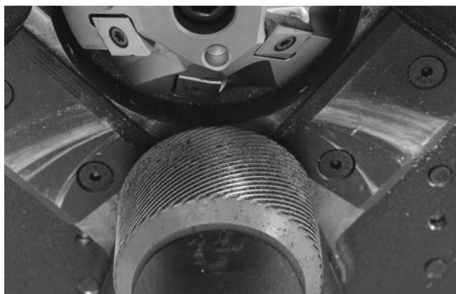
Figura 22 – Superficie moleteada del rodillo de mando, limpia
