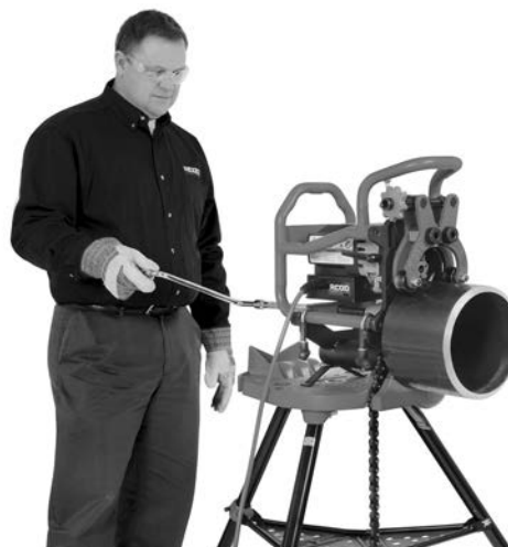
Figura 20C – Operación de biselado (biseladora fija/tubo en rotación)
