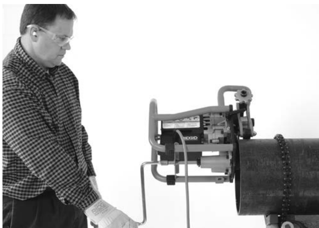
Figura 20A – Operación de biselado (pieza fija/biseladora móvil)
