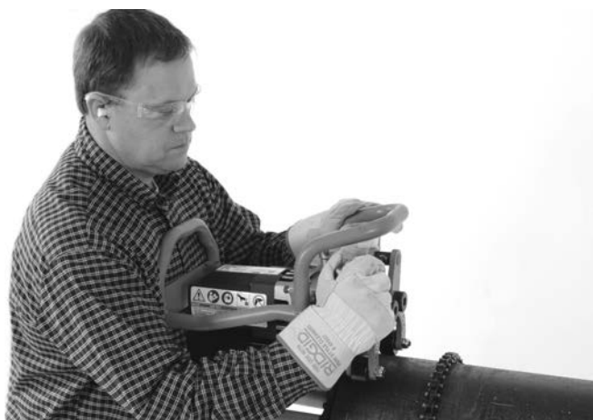
Figure 17A – Serrer la vis de blocage manuellement
