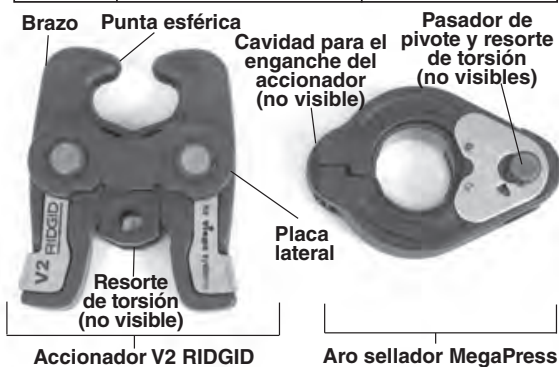
Figura 2 – Aro y accionador MegaPress
