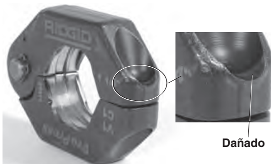
Figura 11 – Cavidad dañada en el aro
