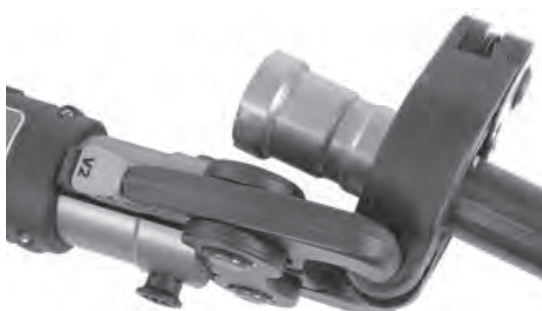
Figure 12B – Engagement à 90° de l'actionneur dans la bague MegaPress en cas de manque de fuite
