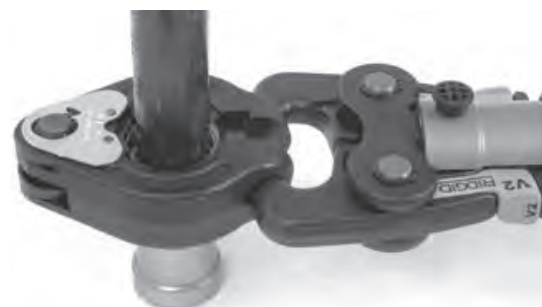
Figure 12A – Engagement des pinces d'actionneur dans les dépressions de bague
