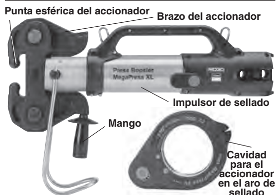
Figura 3 – Aro MegaPress XL, impulsor y accionador Z3
