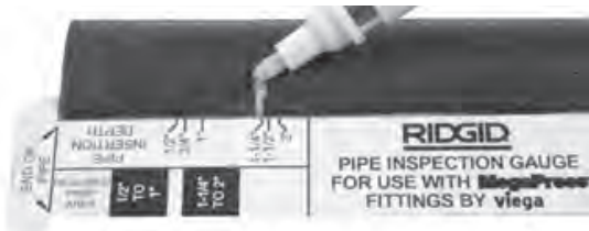
Figura 6B – Valiéndose de un calibre MegaPress® de RIDGID®, marque hasta dónde debe insertarse el tubo dentro del acoplador
