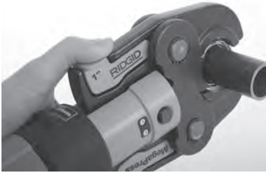
Figure 8 – Ouverture et positionnement des mâchoires MegaPress sur le raccord
