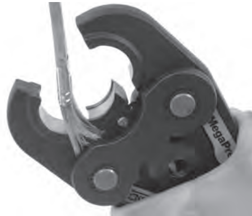
Figure 13 – Nettoyage des axes d'une mâchoire MegaPress
