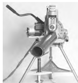
Figura 13 – Tubo desviado cuando la 918 marcha en reversa (REVERSE)
