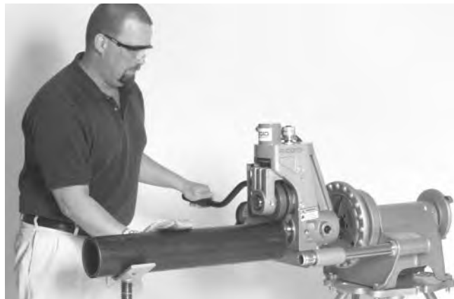
Figura 15 – Operario ejerce presión hacia el lado opuesto a él, con su mano derecha sobre el tubo, cuando el Accionamiento Propulsor está en la modalidad de FOR (adelante).
