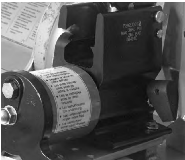
Figura 9 – Primer plano de la palanca de desenganche en la bomba de la 918
