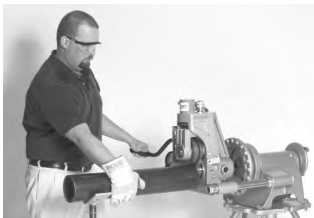
Figura 16 – Operario ejerce presión hacia él, con su mano derecha sobre el tubo, cuando el Accionamiento Propulsor está en la modalidad REV (reversa).
