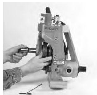
Figura 18 – Se extrae el eje de retención y el rodillo ranurador
