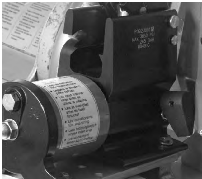
Figure 9 – Détail du levier de verrouillage de pompe de la 918
