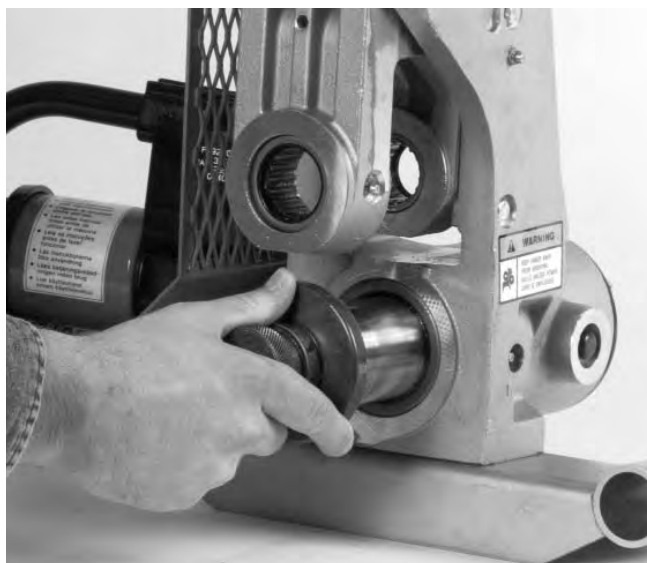
Figura 20 – Extracción del árbol de transmisión
