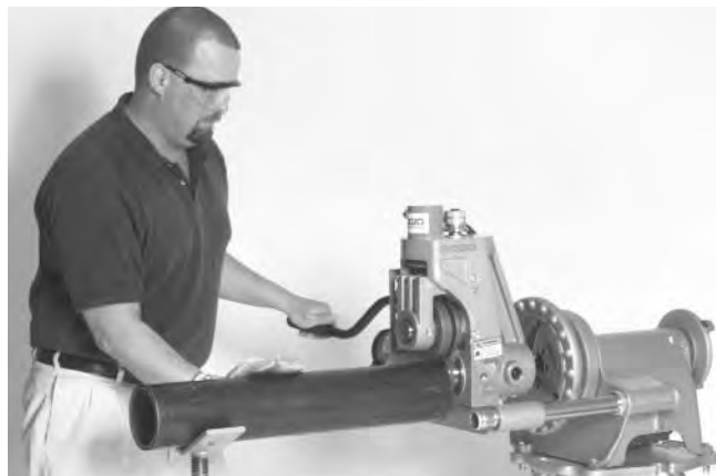
Figure 15 – Rapprochement du tuyau lorsque le moteur d'entraînement tourne en marche avant (FOR)
