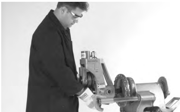
Figura 2 – Instalación del Accionamiento Propulsor No. 300
