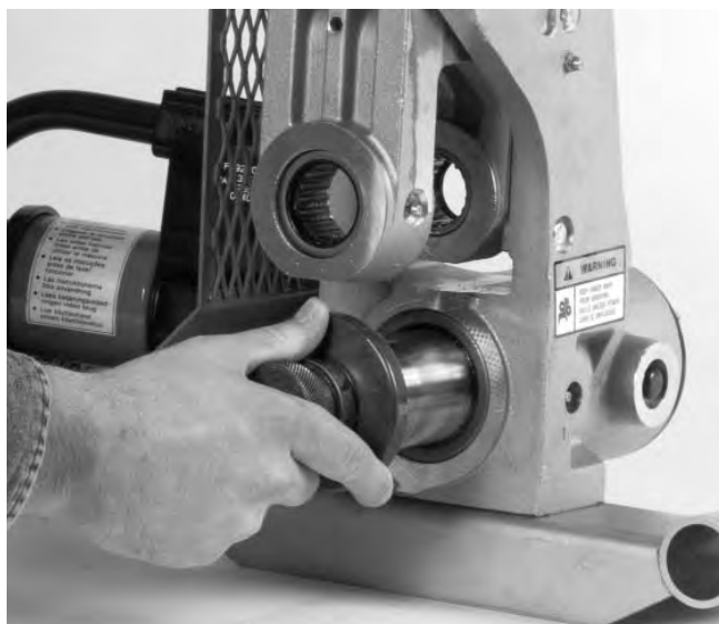
Figure 20 – Retrait de l'arbre d'entraînement
