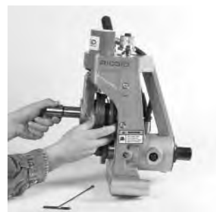
Figure 18 – Retrait de l'arbre et du galet de rainurage
