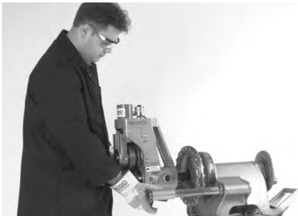
Figure 2 – Montage sur moteur d'entraînement n° 300
