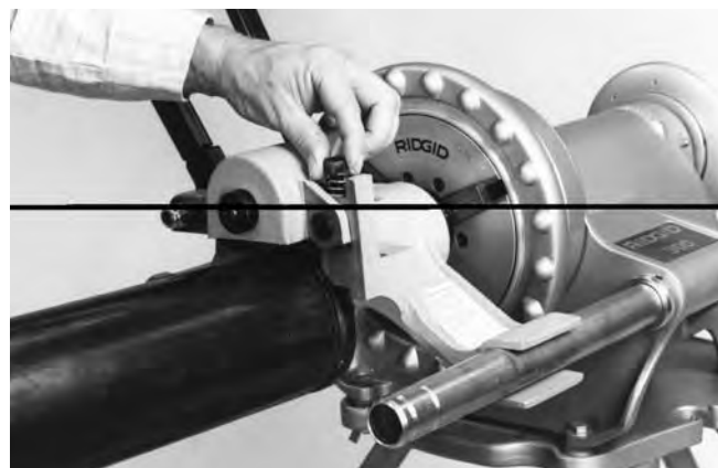
Figure 11 – Serrage de la vis de réglage de profondeur.
