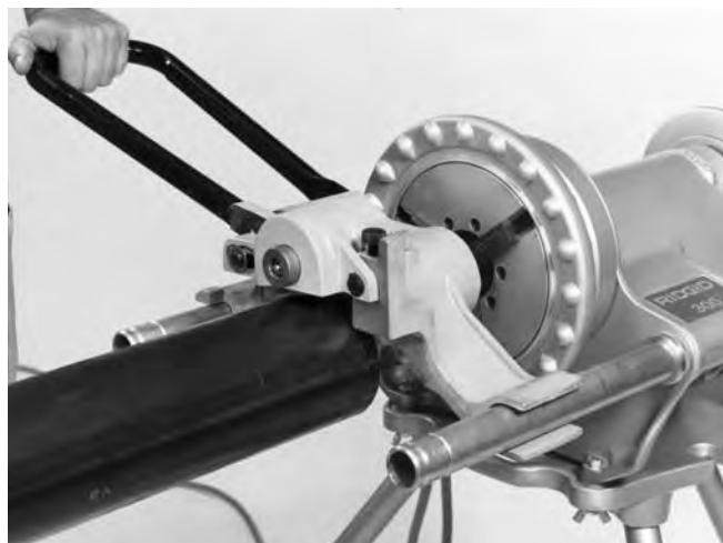
Figure 12 – Exécution du rainurage
