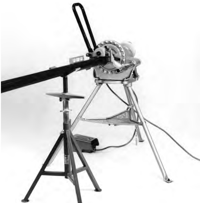
Figure 7 – Nivellement du tuyau.
