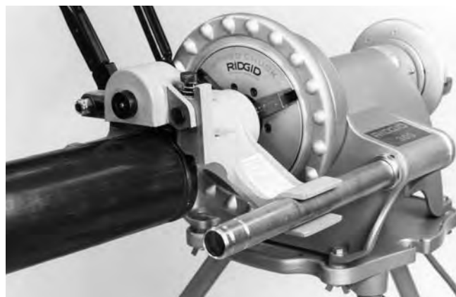
Figure 9 – Levier d'avancement en position relevée
