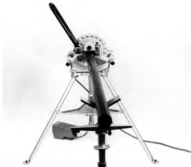
Figure 8B – Desvío del tubo cuando la fuente de accionamiento marcha hacia delante (FOR)
