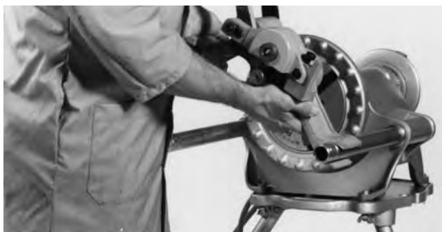
Figure 2 – Montage sur système d'entraînement n° 300
