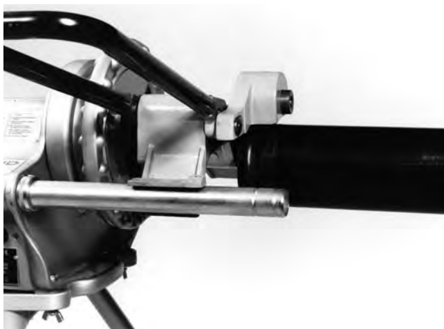
Figure 6 – Equerrage du tuyau et du porte-tubes
