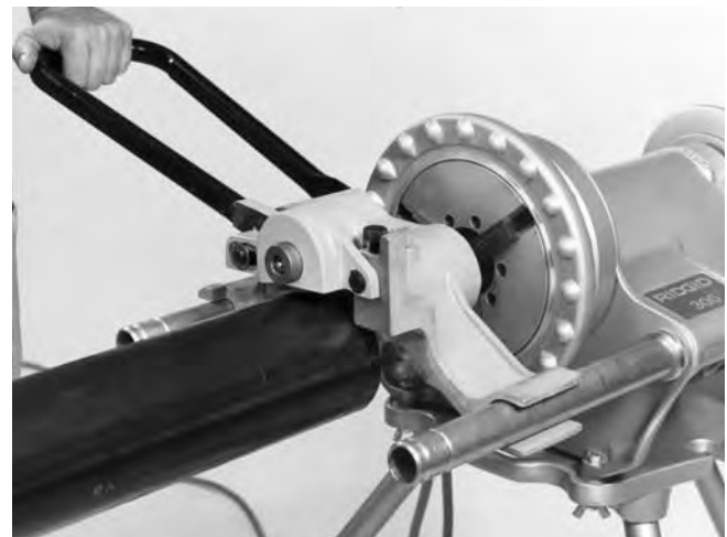
Figura 12 – Formación de una ranura a rodillo
