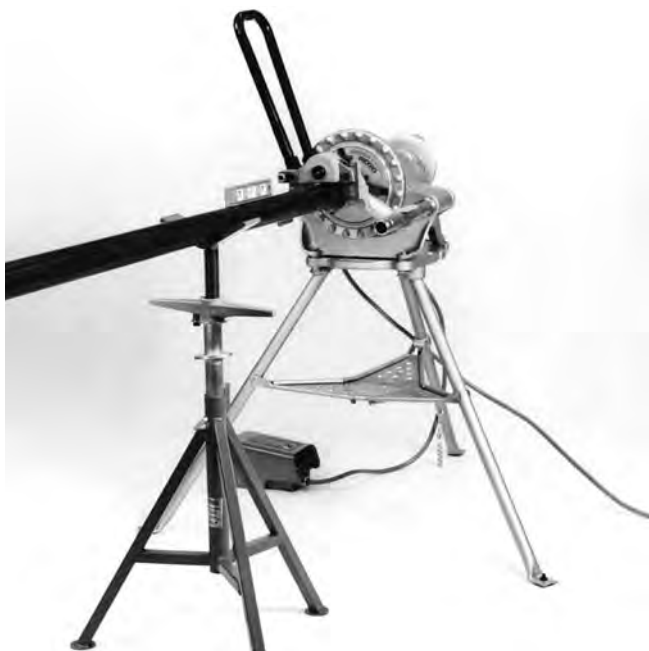
Figura 7 – Nivelación del tubo
