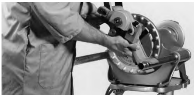
Figura 2 – Montaje sobre el Accionamiento motorizado No. 300
