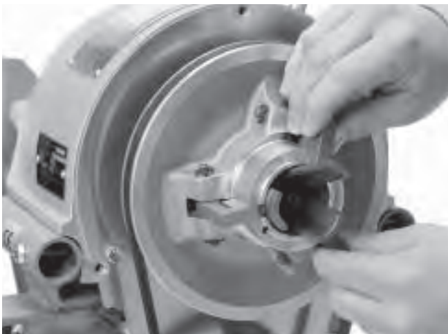
Figura 12 – Recambio de las mordazas del embrague
