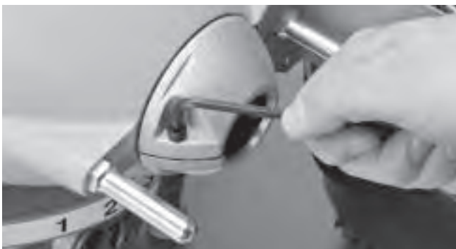
Figura 13 – Eliminación del juego (holgura) del embrague
