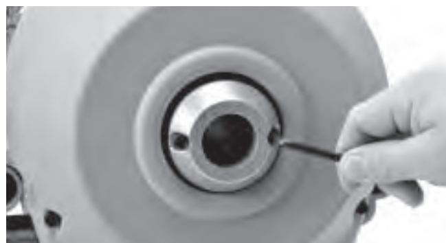
Figura 11 – Recambio de las mordazas del embrague
