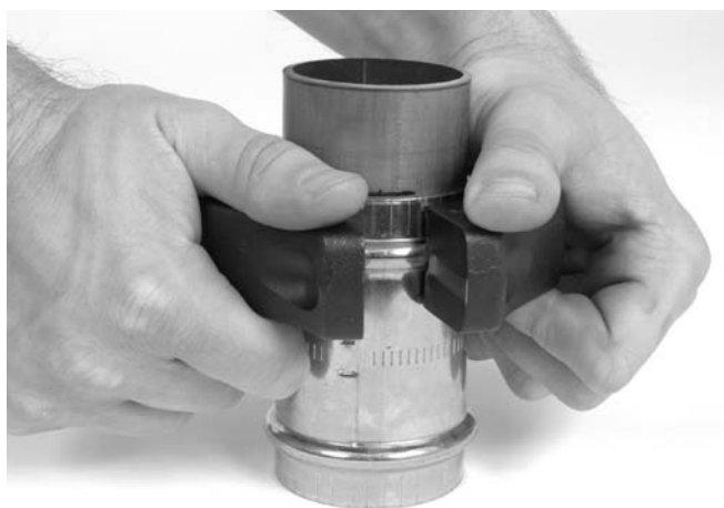
Figura 8 – Montaje del aro sellador en el acoplamiento
