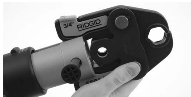
Figura 5 – Para montar el accesorio en la selladora, deslícelo sobre la nariz
