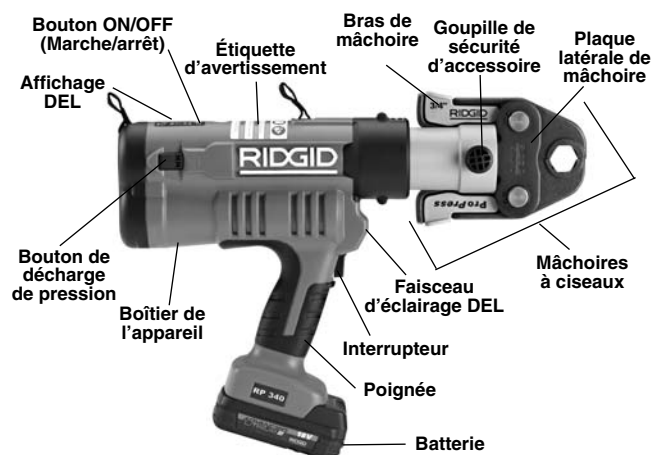
Figure 1 – Sertisseuse RP 340 et mâchoires
