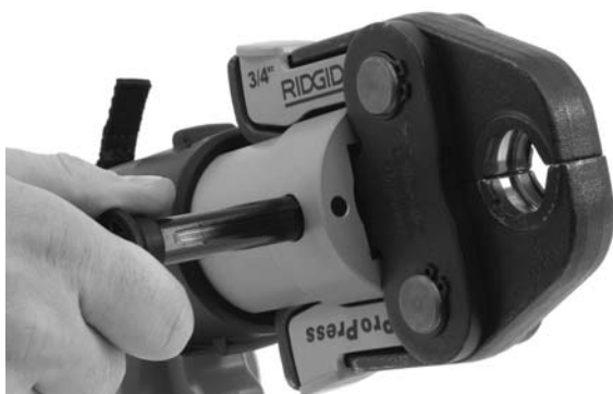
Figure 4 – Goupille de sécurité d'accessoire complètement ouverte
