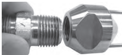
Figura 4 – Instalación del adaptador en el cono
