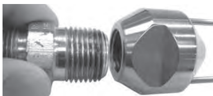
Figure 4 – Montage de l'adaptateur sur le cône
