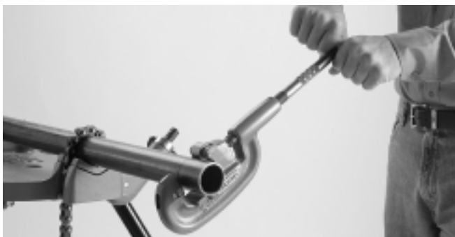
Figure 1 – Coupe de l'extrémité du tuyau
