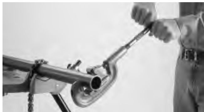
Figura 1 – Corte del extremo del tubo
