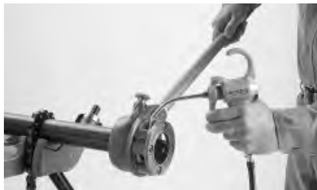
Figure 4 – Application de l'huile de coupe
