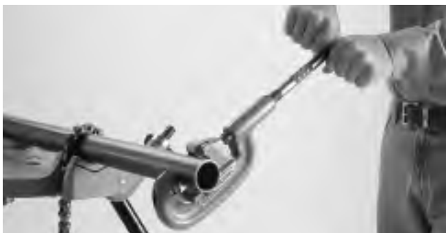
Figure 1 – Coupe de l'extrémité du tuyau
