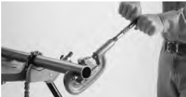
Figure 1 – Coupe de l'extrémité du tuyau
