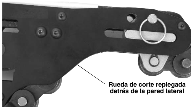
Figura 3A – Pisón totalmente retraído
