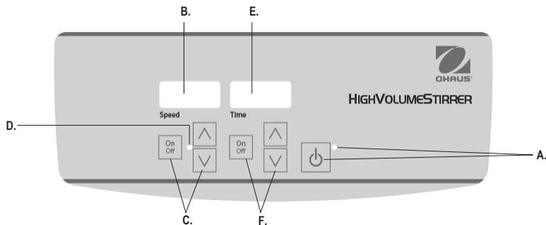
El panel frontal del agitador de alto volumen - STHVDG contiene todos los controles y pantallas necesarios para operar la unidad.
