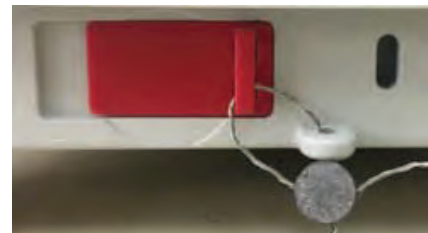
Bloqueado con cable de sellado
