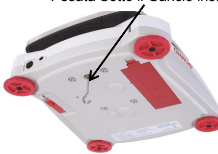
Pesata Sotto il Gancio installato
