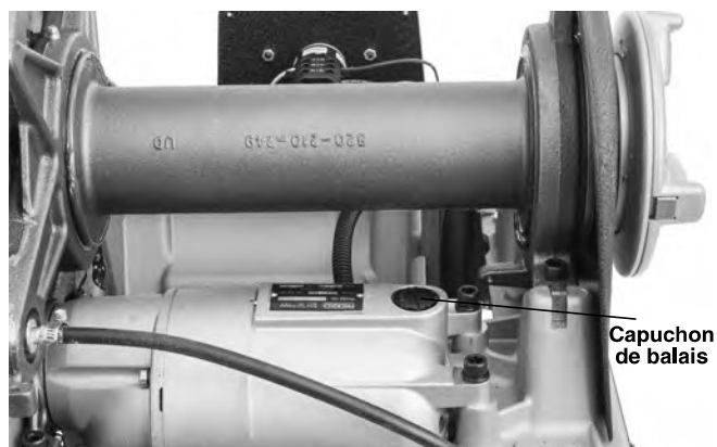
Figure 34 – Retrait du capot et remplacement des balais
