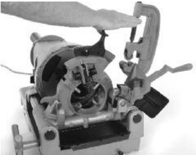
Figure 19 – Fermeture de la tête de filière rétractable
