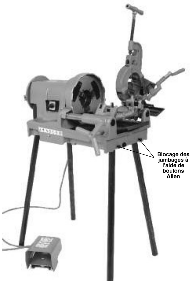
Figure 4 – Fileteuse montée sur jambages tubulaires
