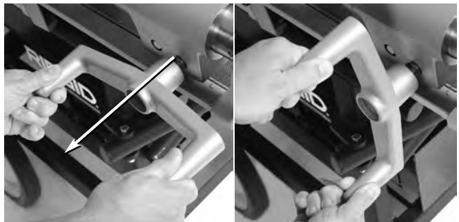
Figure 20 – Réglage du volant du chariot
