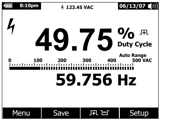
**Figure 26. Duty Cycle Display**
