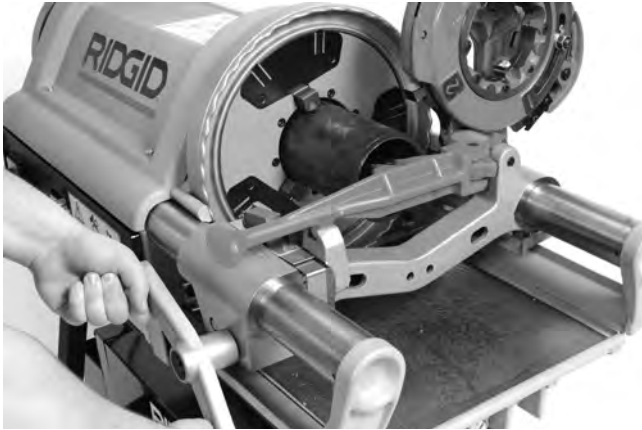
Figura 22 – Escariado de un tubo con el escariador
