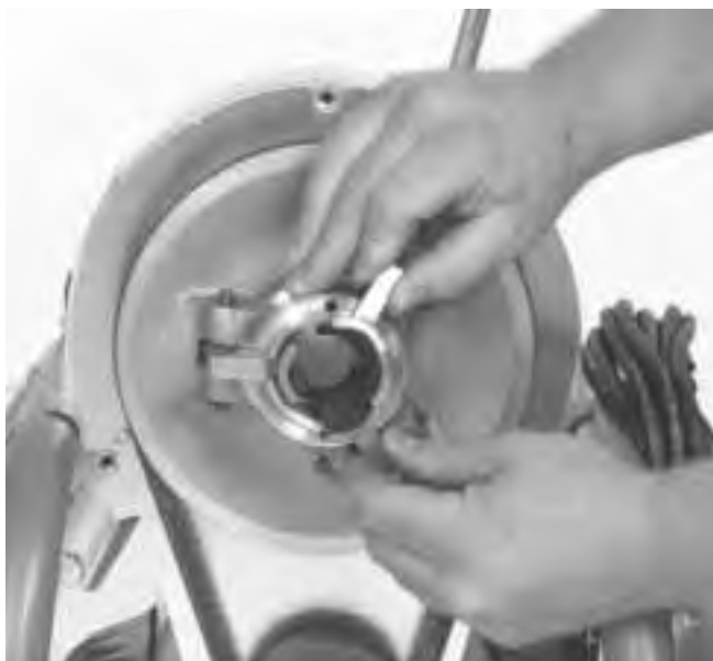
Figure 13 – Remplacement des mâchoires d'embrayage
