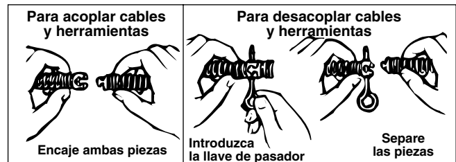
Figura 5 – Modo de acoplar y desacoplar cables y herramientas
