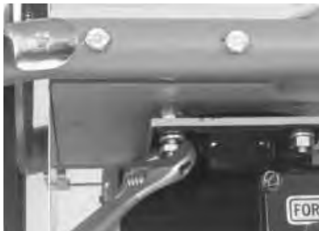
Figure 14 – Élimination du jeu de l'embrayage
