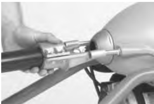
Figure 3 – Montage du guide-câble arrière
