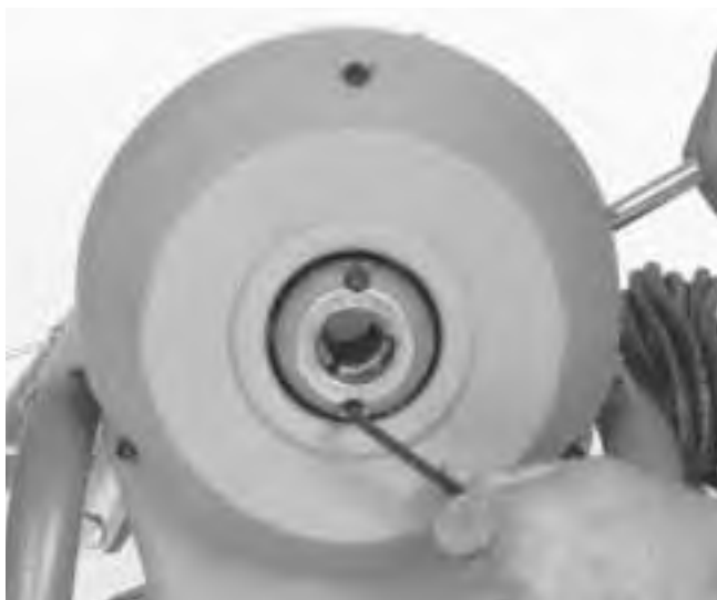
Figure 12 – Remplacement des mâchoires d'embrayage
