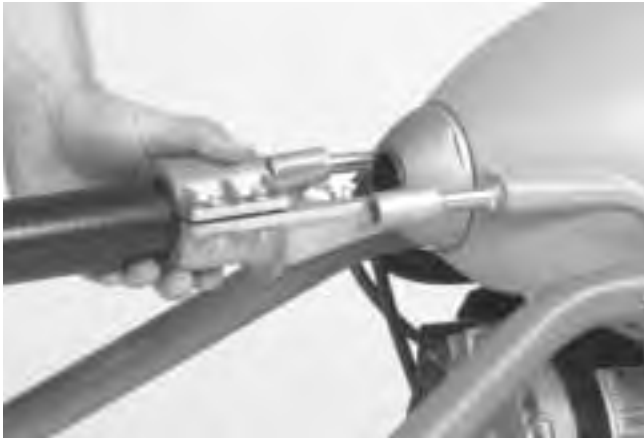
Figura 3 – Acoplamiento de la manguera guía trasera
