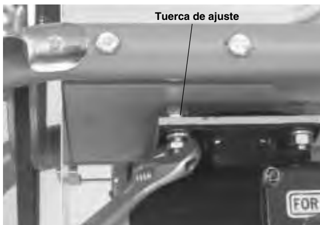
Figura 15 – Regulación de la correa trapezoidal
