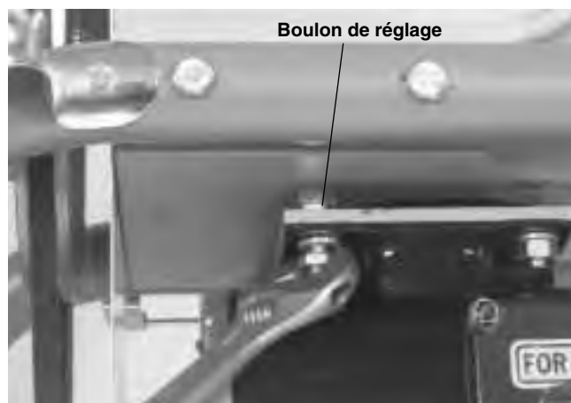
Figure 15 – Réglage de la courroie d'entraînement
