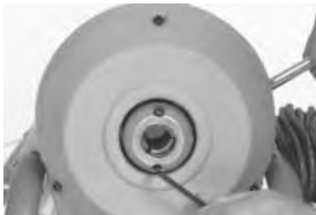
Figura 12 – Recambio de las mordazas del embrague
