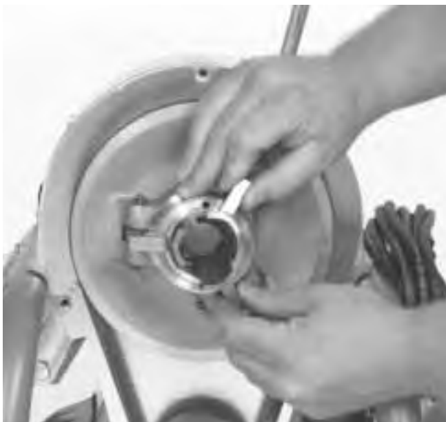
Figura 13 – Recambio de las mordazas del embrague
