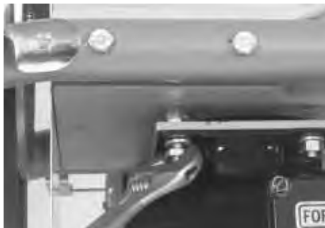
Figura 14 – Eliminación del juego (holgura) del embrague
