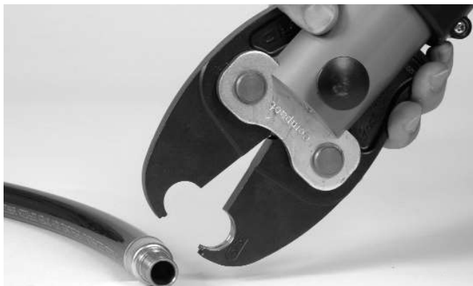
Figure 1 – Ouverture des mâchoires à ciseaux
