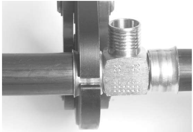
Figura 2 – Mordaza en ángulo recto sobre el acoplamiento PureFlow®
