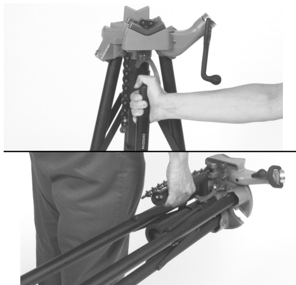
Figura 3 – Modo de llevar la Prensa de Tornillo y su trípode
